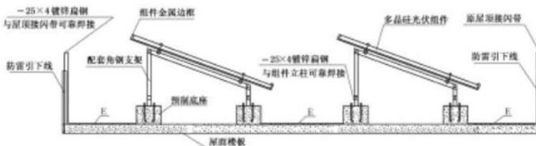
图 A.1 光伏组件防雷接地示意图
